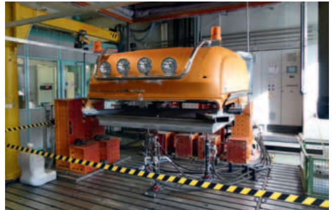
Hydropulstestbank voor de simulatie van gaten en andere oneffenheden in het wegdek.
