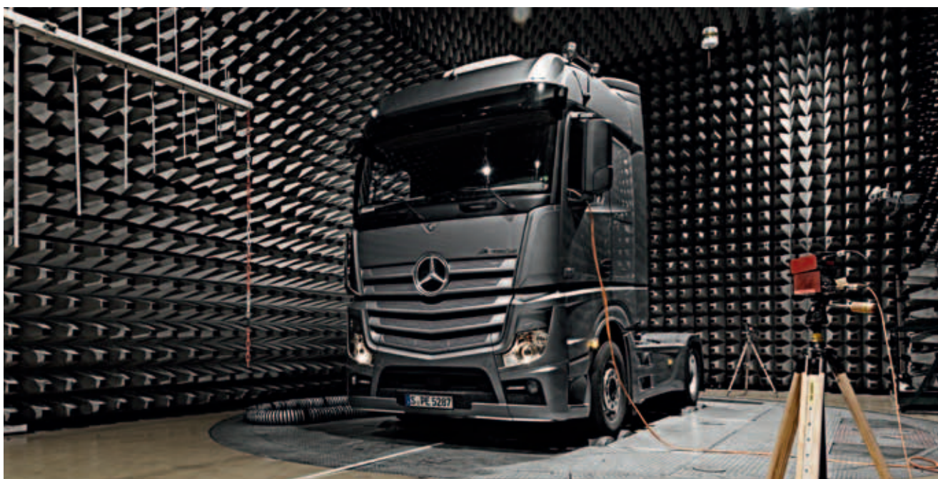
EMC-test in een speciale, tegen elektromagnetische storingen van buitenaf afgeschermd hal.
